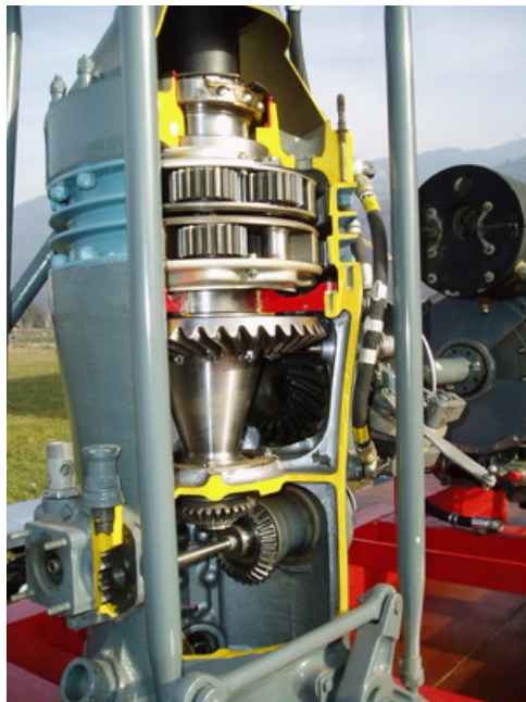
Figure 1 : Une Alouette III avec son réducteur à double train épicycloïdal
